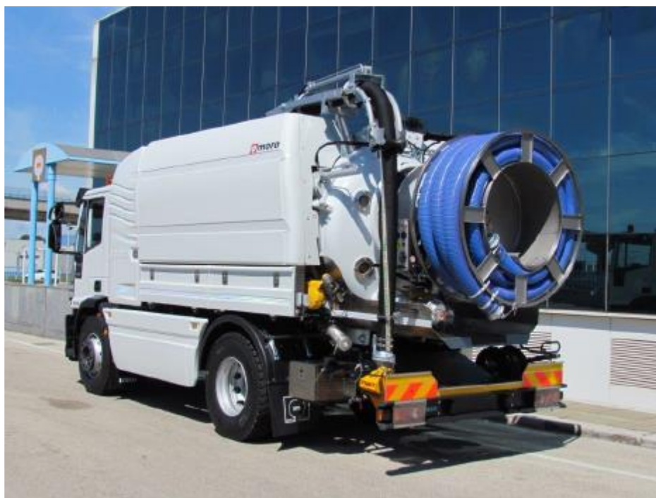
Slika 83 Specijalno kombinirano vozilo za čišćenje sustava odvodnje (primjer)
