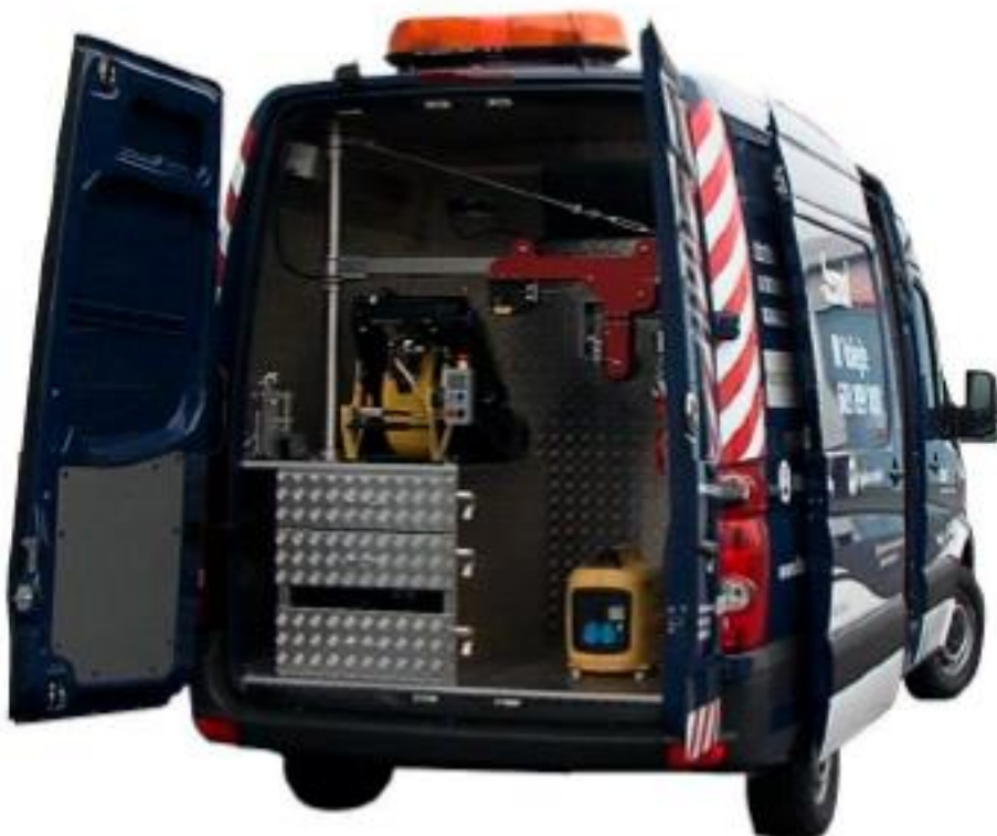
Slika 84 Kombi vozilo sa opremom za TV inspekciju (primjer)
